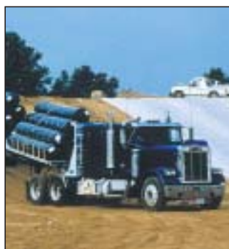
Et lastbillæs bentonitmembraner dækker det samme areal som ca. 250 lastbillæs af komprimeret ler
