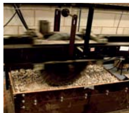
Masketørrelse, form og ribbetykkelse i geonet blev nøje undersøgt hos NTEC.
