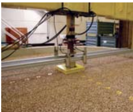
Forsøg på bæreevne udført af BRE bekræfter øget trykspredning med TriAx geonet.
