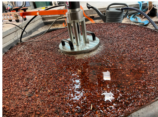
Billede 9: Belastningsforsøg fuldt vandmættet (25-28 cm)
