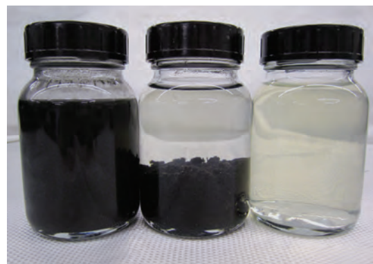
Effekt ved tilsætning af polymer. Glas 1: Ubehandlet slam. Glas 2: Slam blandet med polymer. Glas 3: Slam filtreret gennem geotekstil.
