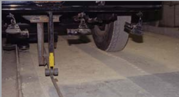
1996 – Tensar geonets øgede spredning af belastningen fører til væsentlig reduktion af sporkøring.
