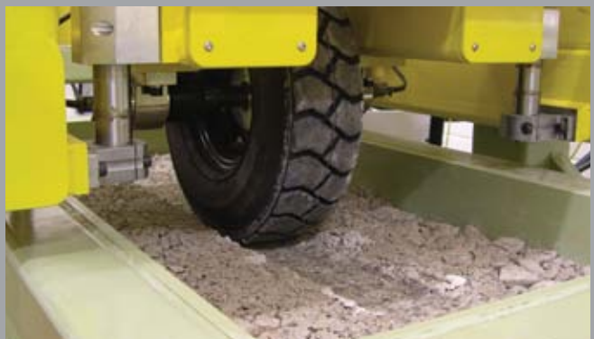
2007 Tensar Teknologi Center – Egne test faciliteter gør det muligt at undersøge forkilings fænomenet mere detaljeret.
