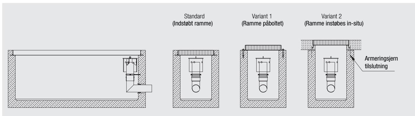
Mod en mindre merpris kan risten enten lægges af på kanten af sandfanget og fastboltes. (Variant 1), eller det kan leveres med armeringsjern i overkanten, så der kan støbes en udsparring til at lægge risten i. (Variant 2)
