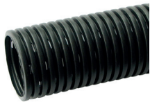
Eurodrain 80/71,5 mm PE-drænrør med 1,8 x 10 mm slids, 50 m
